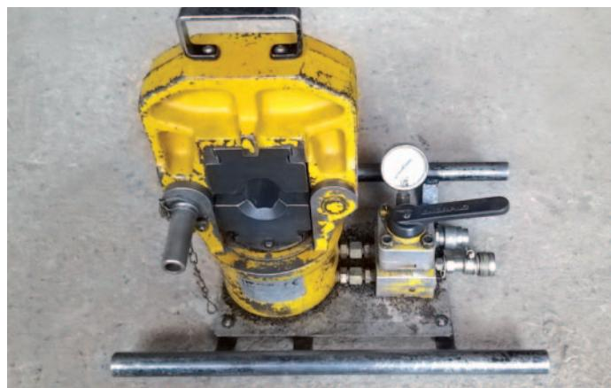
**Hidravlične stiskalnice za spajanje vodnikov različnih dimenzijs do 460 mm<sup>2</sup>**
