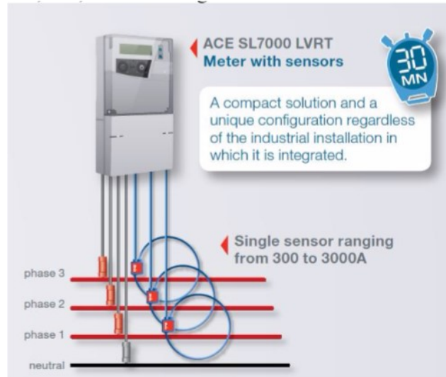
Slika 1: Prikaz namestitve števcu Itron SL7000 DTM s tokovnimi senzorji
